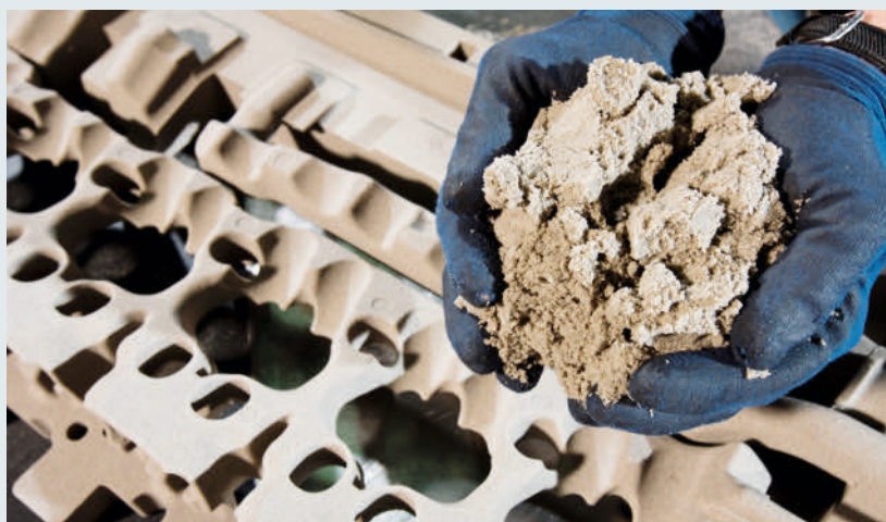
Anorganischer Sandkern: Mit 6 bar Druck wird der speziell präparierte Kernsand in die Form geschossen und dann in rund 60 Sekunden ausgehärtet. Der hier abgebildete anorganische Sand reduziert die Emissionen beim Gießen um 98 Prozent. Bild: BMW
